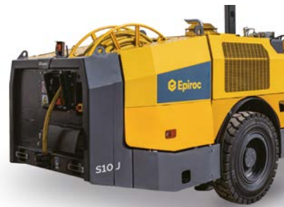
大的电缆卷盘及长的电缆配置，使得钻车工作范围得到延伸。高的离地间隙为颠簸路面行车提供高性能。
